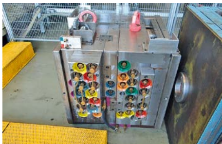
Farbige Kennzeichnung der jeweiligen Temperierkreisläufe
